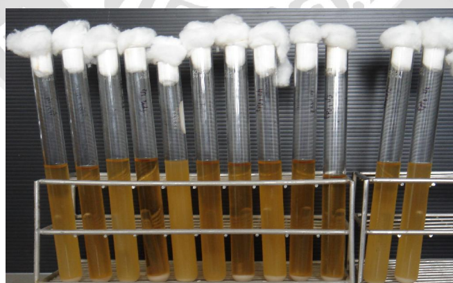
ภาพที่ 4.6 แสดงผลการทดสอบการสร้างแก๊ส
