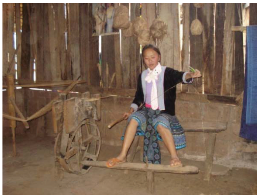
ภาพที่ 71 ตีนดั่ว เครื่องมือเฉพาะในการปั่นเส้นใยกล้วยง ภาพที่ 72 การปั่นเส้นใยกล้วยงให้เป็นเกลียว
