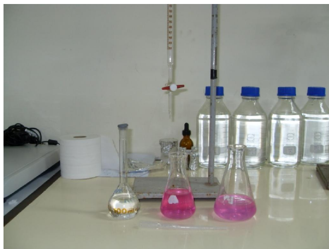
ภาพผนวกที่ 3 อุปกรณ์สารเคมีและขั้นตอนการไทเทรตหาปริมาณคาร์บอนไดออกไซด์
