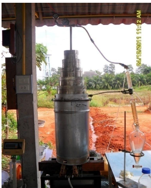
ภาพที่ 26 การกลั่นเอทานอลจากลำไยตกเกรด (แบบกะ)
