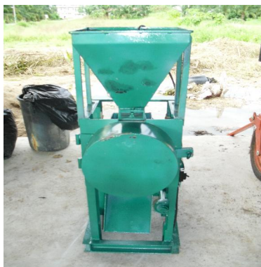
ภาพที่ 6 ต้นแบบเครื่องอัดเม็ดปุ๋ยอินทรีย์จากลำไยตกเกรด
