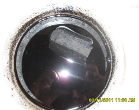
ภาพที่ 8 กระบวนการกระตุ้นพื้นผิวถ่านกัมมันต์ด้วยกรดฟอสฟอริก
