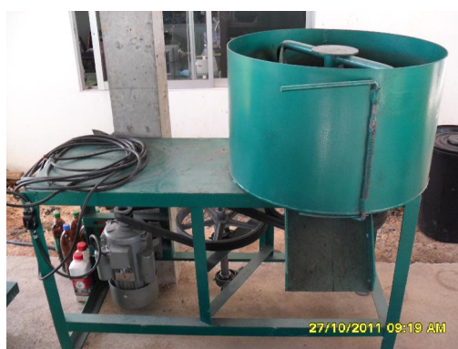
ภาพที่ 5 ต้นแบบเครื่องผสมปุ๋ยอินทรีย์จากลำไยตกเกรด
