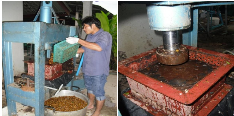
ภาพที่ 11 การบีบน้ำอัดเอาน้ำลำไยด้วยเครื่องอัดไฮโดรลิก
