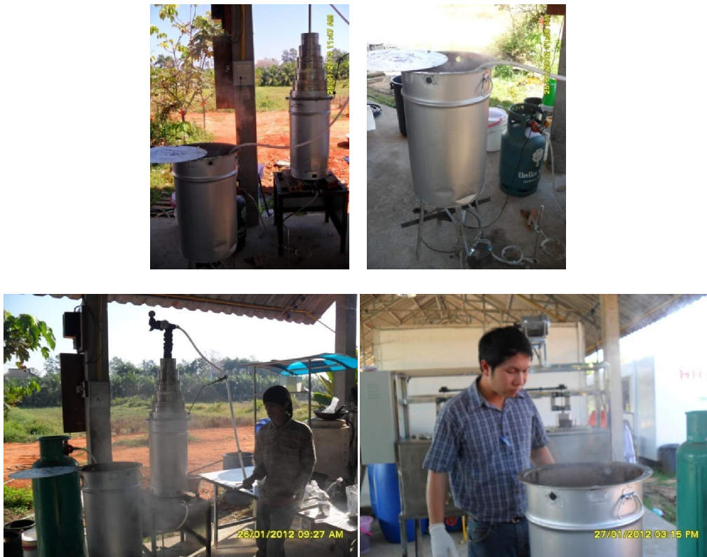
ภาพที่ 7 กระบวนการกระตุ้นพื้นผิวผ่านกัมมันต์ด้วยไอน้ำที่อุณหภูมิและความดันต่างๆ
