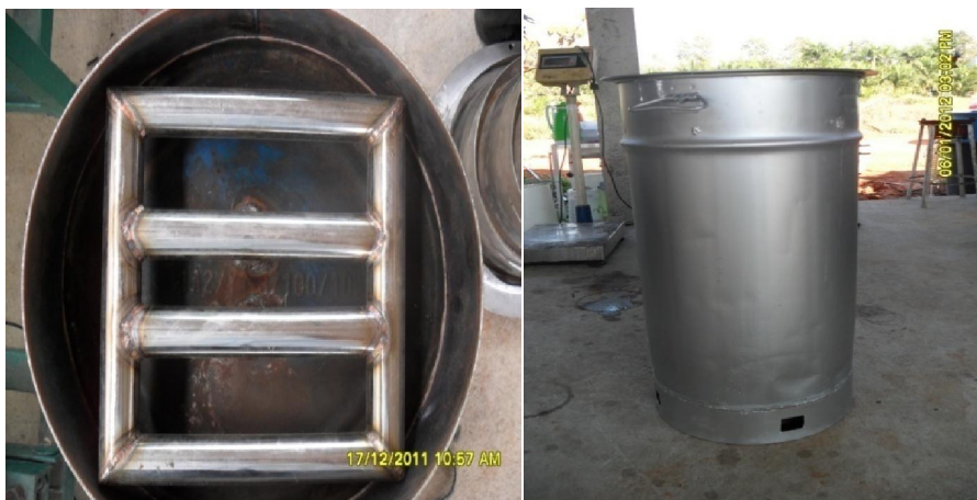
ภาพที่ 25 ตัวถังต้มน้ำสาที่มีการดัดแปลงโดยการให้ความร้อนจากการเผาฟอสเฟตเตนเลส
