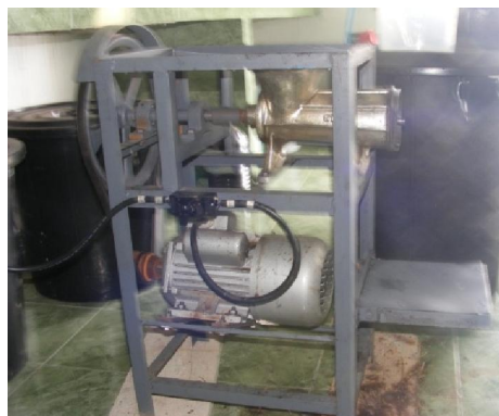
ภาพที่ 12 เครื่องบดละเอียดลำไยก่อนที่จะนำไปต้มเพื่อฆ่าเชื้อโรคและสกัดน้ำตาล
