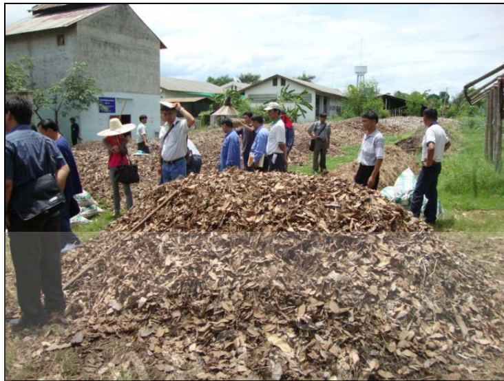
ภาพที่ 23 การใช้เศษใบไม้และมูลสัตว์ 3 ต่อ 1 โดยปริมาตรเป็นวัสดุกรองกลิ่นชีวภาพ (Biofilter)
