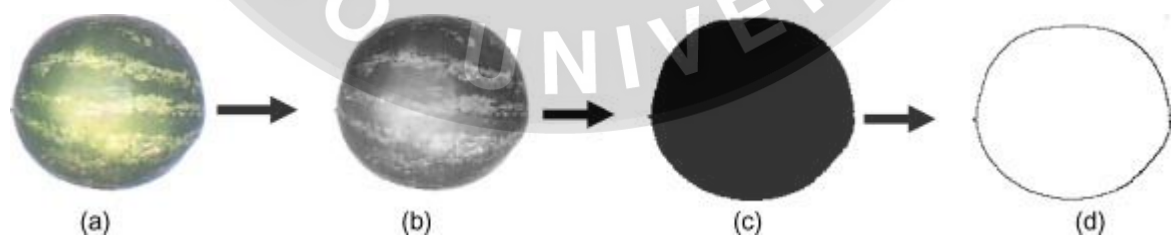
ภาพที่ 14 (a) ภาพแตงโมแบบ RGB (b) ภาพแตงโมแบบ 8 บิต (c) ภาพแตงโมแบบไบนารี (d) เส้นขอบของแตงโม (Koc, 2007)
