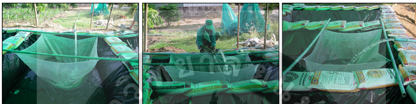
ภาพที่ 10 การเติมน้ำจากคลองชลประทานผ่านผ้ากรองลงบ่อทดลองแต่ละบ่อในการทดลองที่ 2
