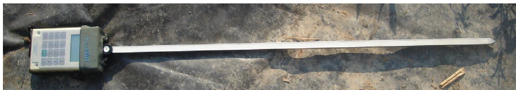
ภาพที่ 1 เครื่องวัดความเข้มแสง (Plant Canopy Instrumentation) รุ่น Accu PAR ยี่ห้อ Decacon® ผลิตจากสหรัฐอเมริกา
