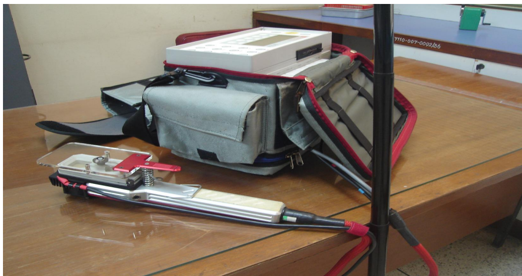
ภาพที่ 2 เครื่องวัดอัตราการสังเคราะห์แสง (Leaf Chamber Analyser; LCA-4)
