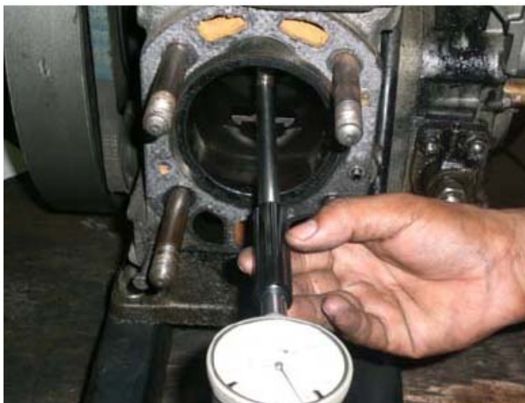
ภาพที่ ง.3 การวัดเส้นผ่านศูนย์กลางภายในกระบอกสูบ
