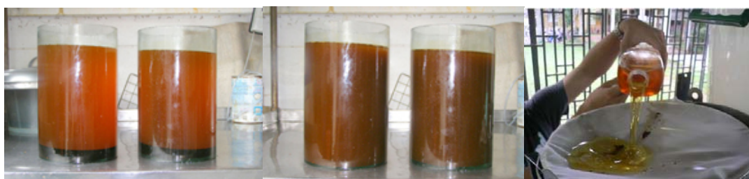
ภาพที่ 2.10 การเตรียมน้ำมันใช้แล้วเพื่อผลิตไบโอดีเซล
