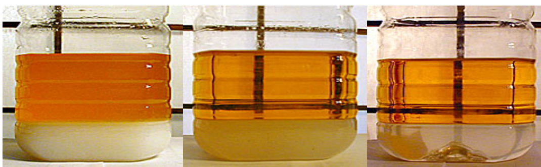
ก. การล้างน้ำมันไบโอดีเซลจากกระบวนการผลิตไบโอดีเซลด้วยแรงคน
