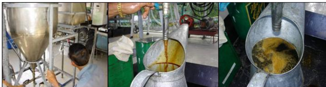
ข. การแยกชั้นของกลีเซอรินและการแยกกลีเซอรินออกจากน้ำมันไบโอดีเซลด้วยเครื่องผลิต
