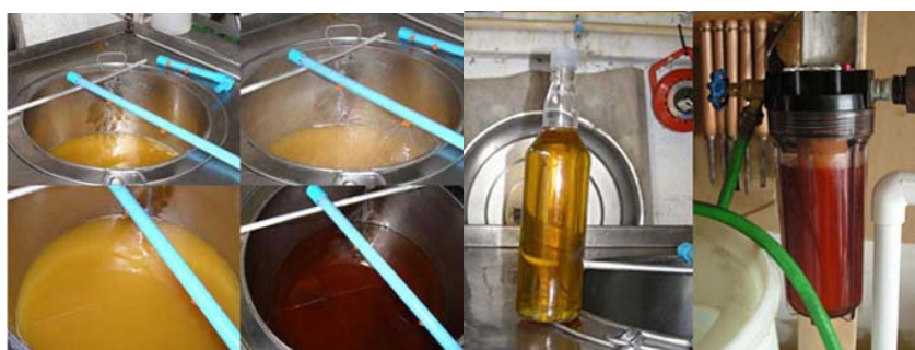
ภาพที่ 2.15 การกำจัดน้ำหรือการไล่ความชื้นออกจากน้ำมันไบโอดีเซล
