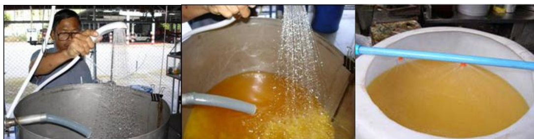
ข. การล้างน้ำมันไบโอดีเซลจากกระบวนการผลิตไบโอดีเซลด้วยเครื่องผลิต
