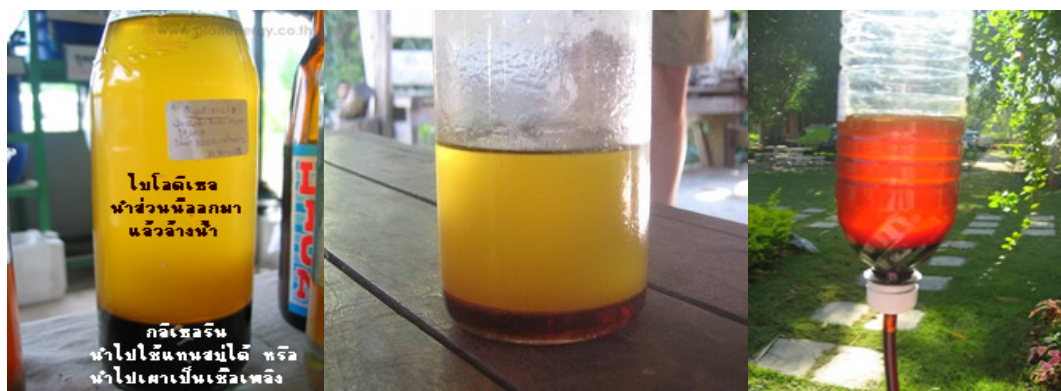
ก. การแยกชั้นของกลีเซอรินและการแยกกลีเซอรินออกจากน้ำมันไบโอดีเซลด้วยแรงคน
