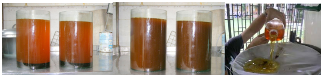
ภาพที่ 4.3 การเตรียมน้ำมันใช้แล้วเพื่อผลิตไบโอดีเซล
