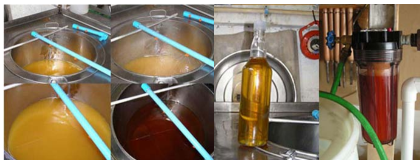
ภาพที่ 4.8 การกำจัดน้ำหรือการไล่ความชื้นออกจากน้ำมันไบโอดีเซล
