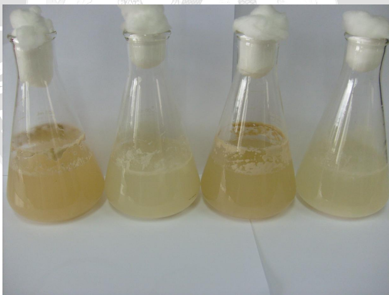
ภาพภาคผนวกที่ 8 น้ำเสียที่ผ่านการบำบัดแบบเติมอากาศและไม่เติมอากาศ
