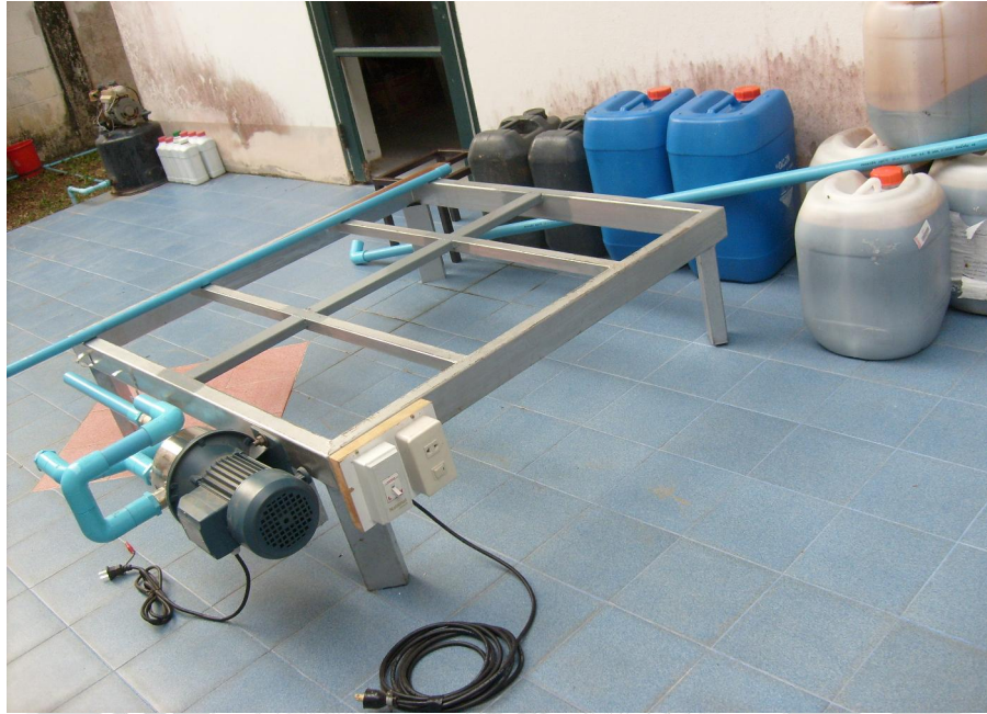
ภาพภาคผนวกที่ 10ฐานวางถังหมักจุลินทรีย์
