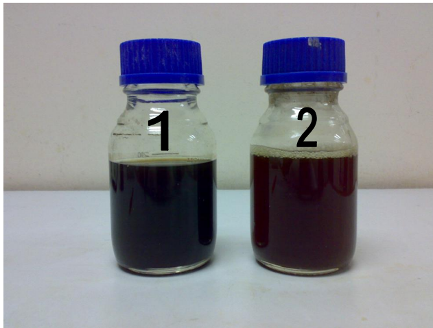
ภาพ 39 ประสิทธิภาพการลดความเข้มข้นน้ำกากส่าสังเคราะห์โดยเชื้อยีสต์ NG-06 ภายใต้สภาวะที่ไม่มีการเขย่า ที่อุณหภูมิห้อง (1) Control, (2) ไม่เขย่า
