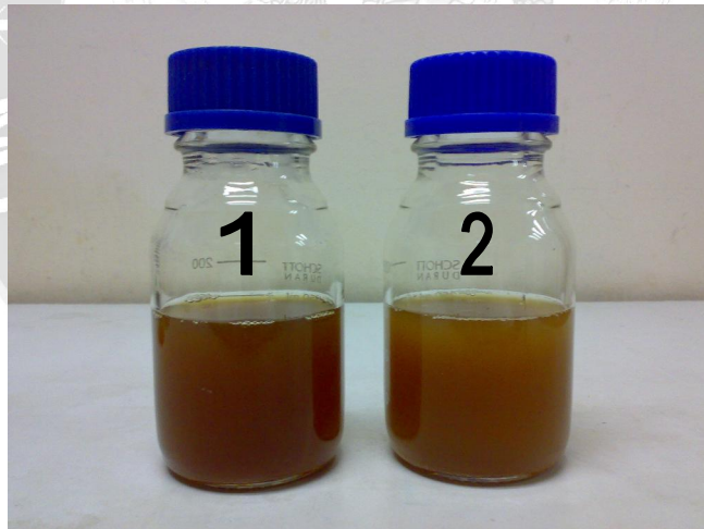
ภาพ 49 ประสิทธิภาพการลดความเข้มข้นน้ำจากสาจากบ่อหมักเดิม PDB ที่ผ่านการย่อย โดยเชื้อราขาว PKM 3 แล้วเติมสารอาหารด้วยเชื้อยีสต์ NG-06 ในวันที่ 6 ของการทดลอง (1) Control, (2) เติมน้ำ
