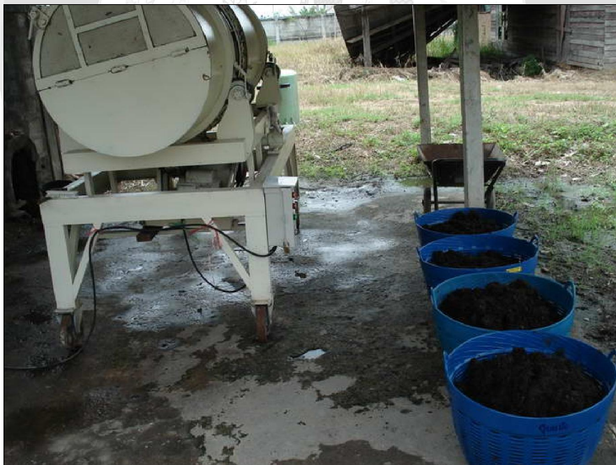
ภาพที่ 17 การนำปุ๋ยหมักที่เสถียรมาทำให้แห้งภายในเข่งพลาสติก
