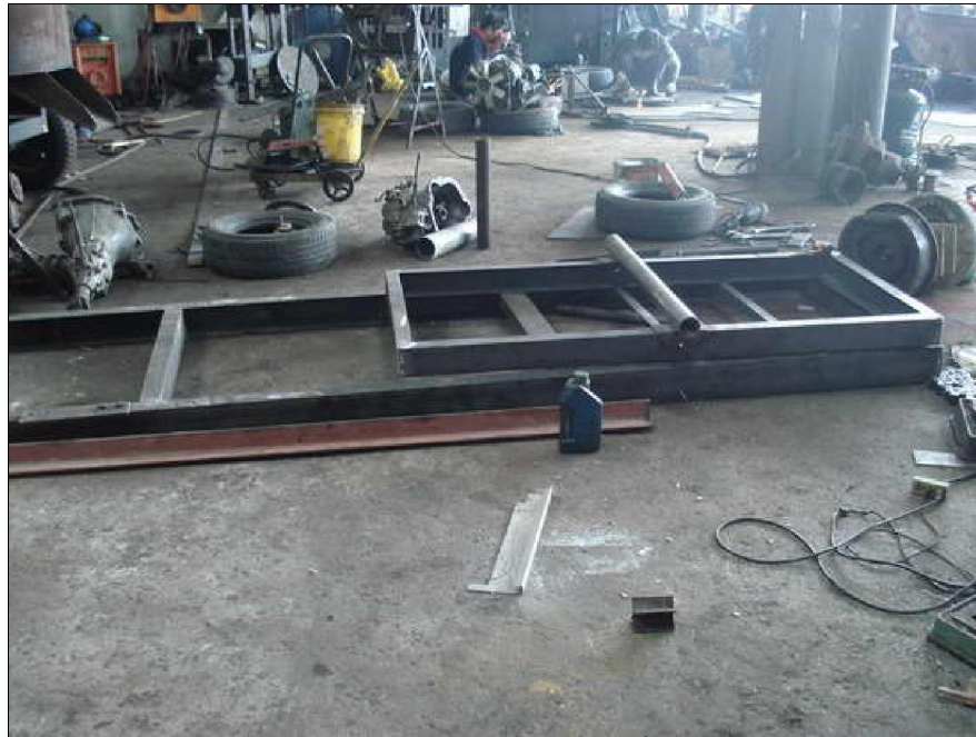
ภาพที่ 2 การประกอบชุดโครงขาตั้งถังหมุน
