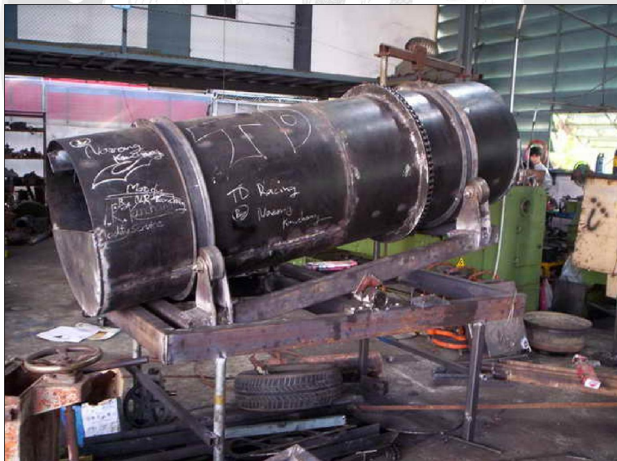
ภาพที่ 3 การประกอบถังหมุนเข้ากับโครงขาตั้ง
