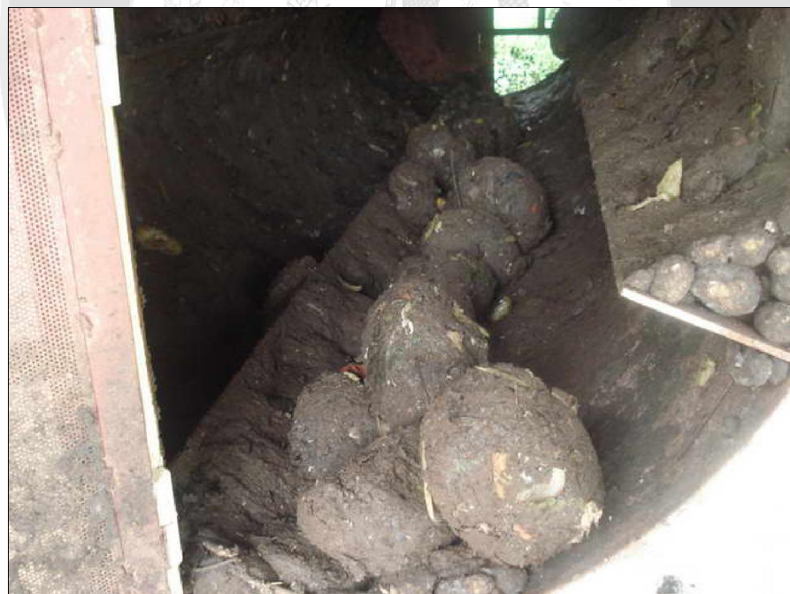
ภาพที่ 13 การเกิดเป็นก้อนกลมขนาดใหญ่จากผลของการที่วัสดุแห้งเกินไปและการพลิกกลับ ภายในถัง
