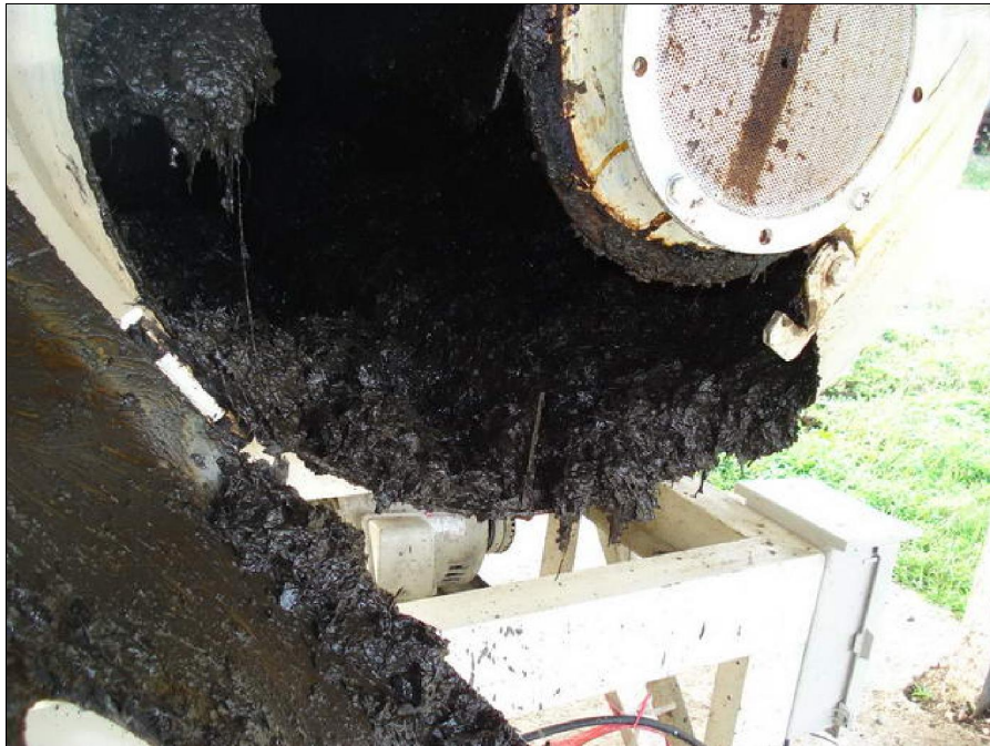
ภาพที่ 12 การเปื้อกขึ้นมากเกินไปของวัสดุทำให้มีกลิ่นเหม็น
