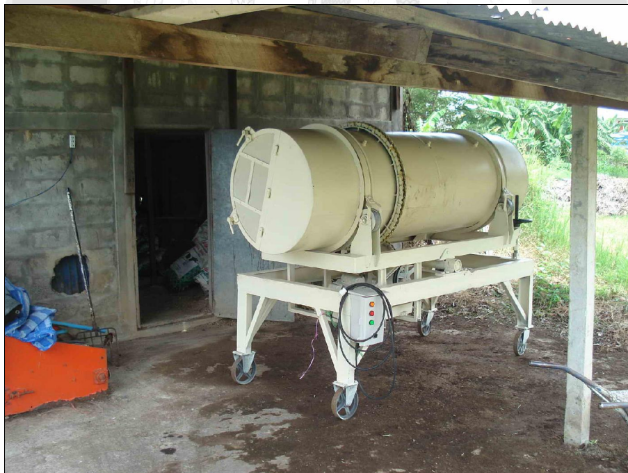
ภาพที่ 9 ระบบถังหมน ณ ศูนย์สาธิตการผลิปุ๋ยหมักระบบกองเดิมอากาศ แม่ใจ 70 ปี
