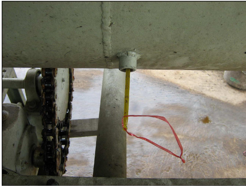
ภาพที่ 24 การวัดอุณหภูมิวัสดุภายในถังหมุน
