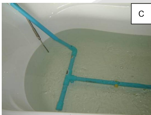
ภาพภาคผนวกที่ 7 อุปกรณ์ประกอบการทดลองเครื่องน้ำร้อน ได้แก่ อ่างน้ำร้อนขนาดบรรจุ ประมาณ 120 ลิตร (A) ระบบทำน้ำร้อนที่ดัดแปลงจากเครื่องทำน้ำอุ่นใน ครัวเรือน (B) ระบบหมุนเวียนน้ำในอ่างโดยใช้ท่อพีวีซีเจาะรู (C) และระบบ ควบคุมอุณหภูมิอัตโนมัติ (D)
