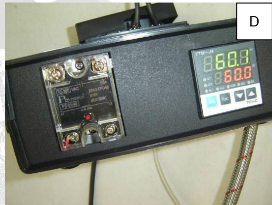
ภาพภาคผนวกที่ 7 อุปกรณ์ประกอบการทดลองเครื่องน้ำร้อน ได้แก่ อ่างน้ำร้อนขนาดบรรจุ ประมาณ 120 ลิตร (A) ระบบทำน้ำร้อนที่ดัดแปลงจากเครื่องทำน้ำอุ่นใน ครัวเรือน (B) ระบบหมุนเวียนน้ำในอ่างโดยใช้ท่อพีวีซีเจาะรู (C) และระบบ ควบคุมอุณหภูมิอัตโนมัติ (D)
