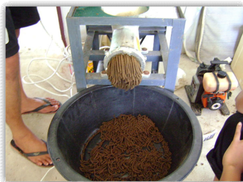
ภาพผนวกที่ 11 การบดวัตถุดิบอาหารผสมด้วยเครื่องบดอาหาร (mincer)
