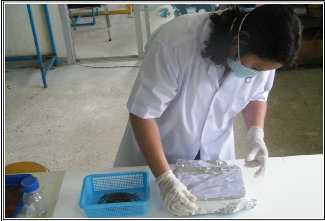
ภาพที่ 7 การเก็บรักษาตัวอย่างโครงร่างเปลือกปูด้วยกระดาษอลูมิเนียมฟรอยด์ ก่อนนำไปใส่ในตู้ควบคุมอุณหภูมิ
