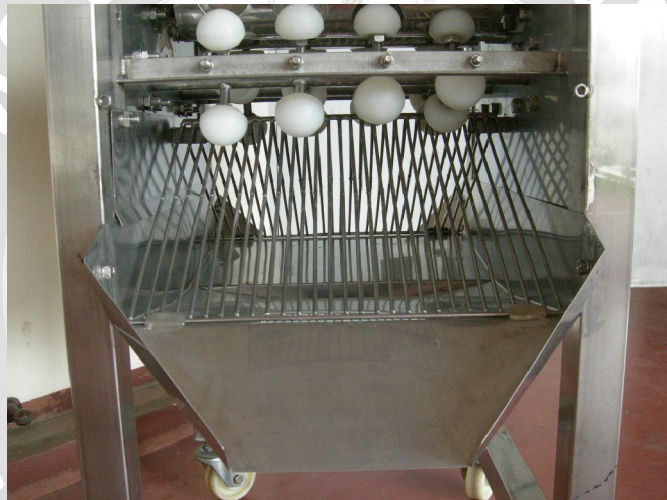
รูปที่ 3.12 ตะแกรงคัดแยกน้ำส้มและเปลือกส้ม
