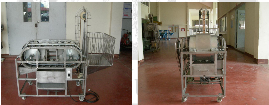
รูปที่ 2.24 แสดงด้านข้างและด้านหน้าของเครื่องคั้นน้ำส้มต้นแบบเพื่อทดสอบ
