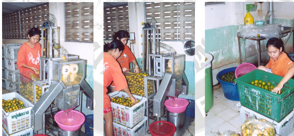
รูปที่ 2.23 การป้อนพร้อมคัดผลส้ม (ซ้าย) การลำเลียงส้ม (กลาง) และการล้างส้ม (ขวา)
