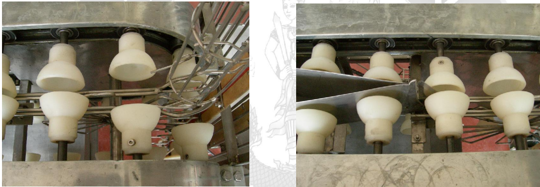
รูปที่ 2.26 ระบบการจับผลส้มและลำเลียงผลส้มเข้าสู่ระบบคั้น (ซ้าย) ชุดผ่าผลส้ม(ขวา)
