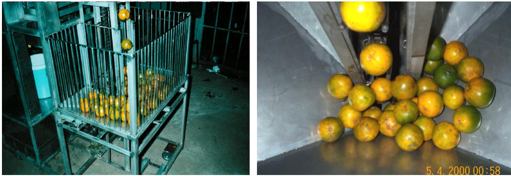
รูปที่ 2.14 ตะกร้าที่ทำจากสเตนเลส (ซ้าย) และมุมตะกร้าประมาณ 45 องศา (ขวา)
