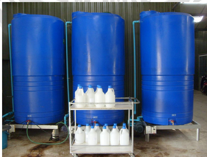
ภาพที่ 11 ถังหมักหัวเชื้อจุลินทรีย์แม่ใจ (Maejo Fermenter)
