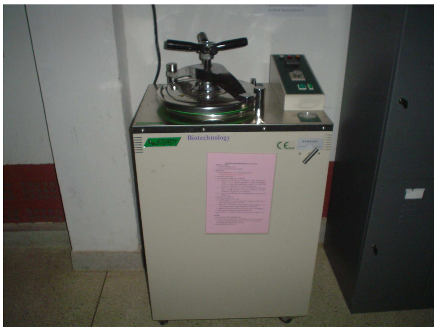
ภาพภาคผนวก ข-3 หม้อไอน้ำความดันไอน้ำ (Autoclave)
