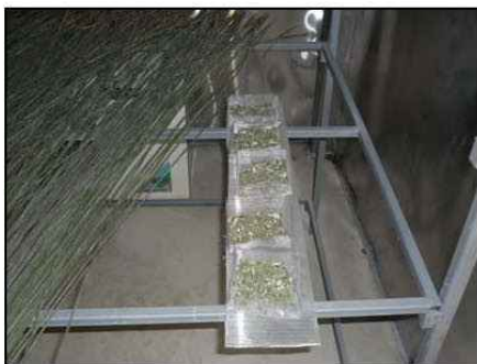
ภาพที่ 3 ตัวอย่างกระจูดอบแห้งที่วางบนชั้นวางในห้องอบแห้งและตัวอย่างกระจูดตากแห้งกลางแจ้ง
